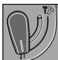
Posisjon til boring uten slag i tre, metall, keramikk og kunststoff pluss til skruing
