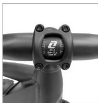
Po: kierownica zamontowana
