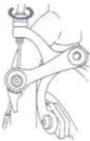
rys. 12b regulacja napięcia linki hamulca
