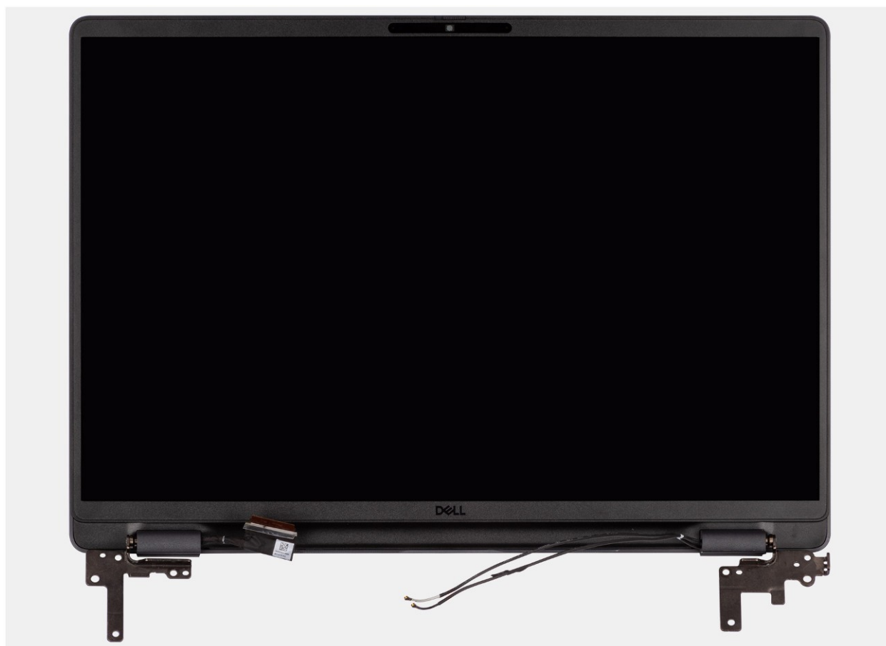
Rysunek 64. Wymontowywanie zestawu wyświetlacza
