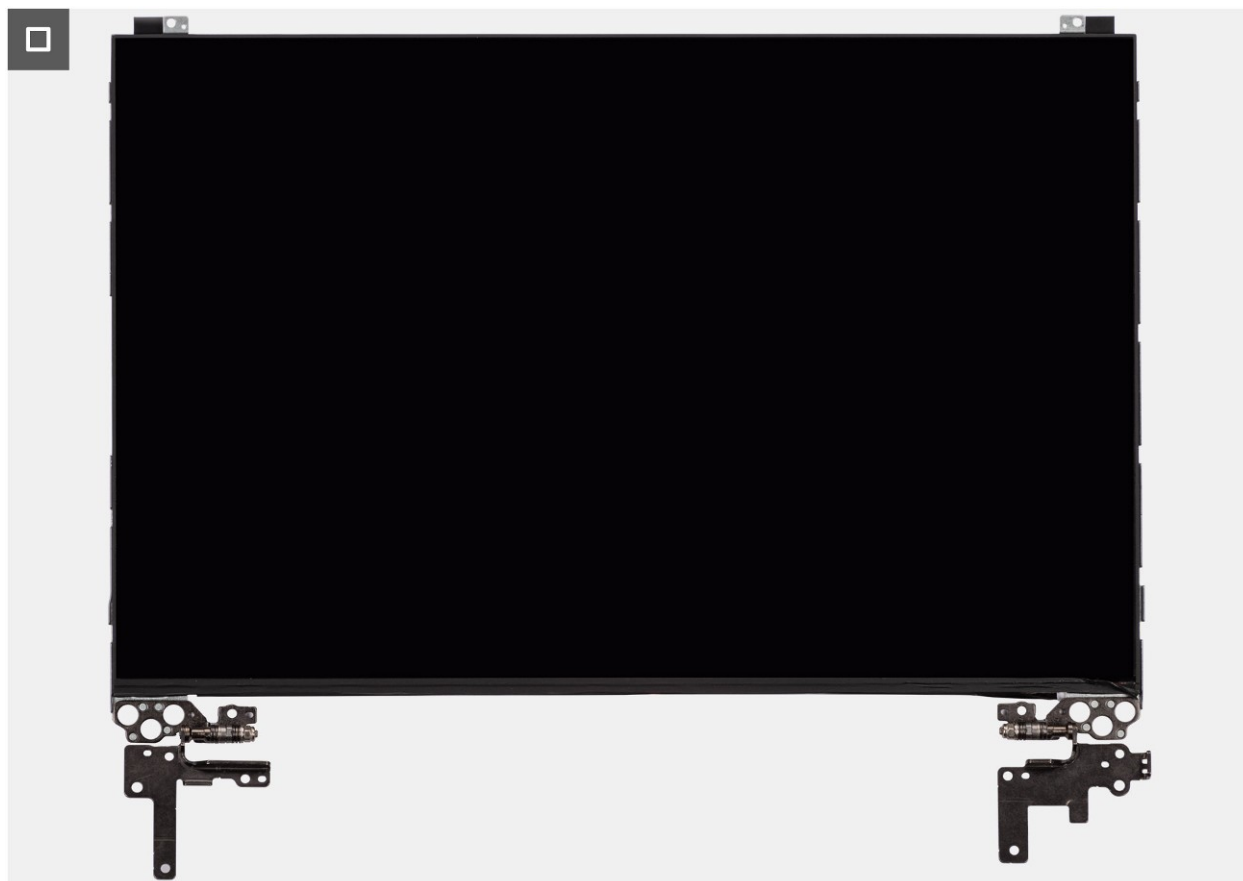
Rysunek 77. Wymontowywanie zestawu panelu wyświetlacza
