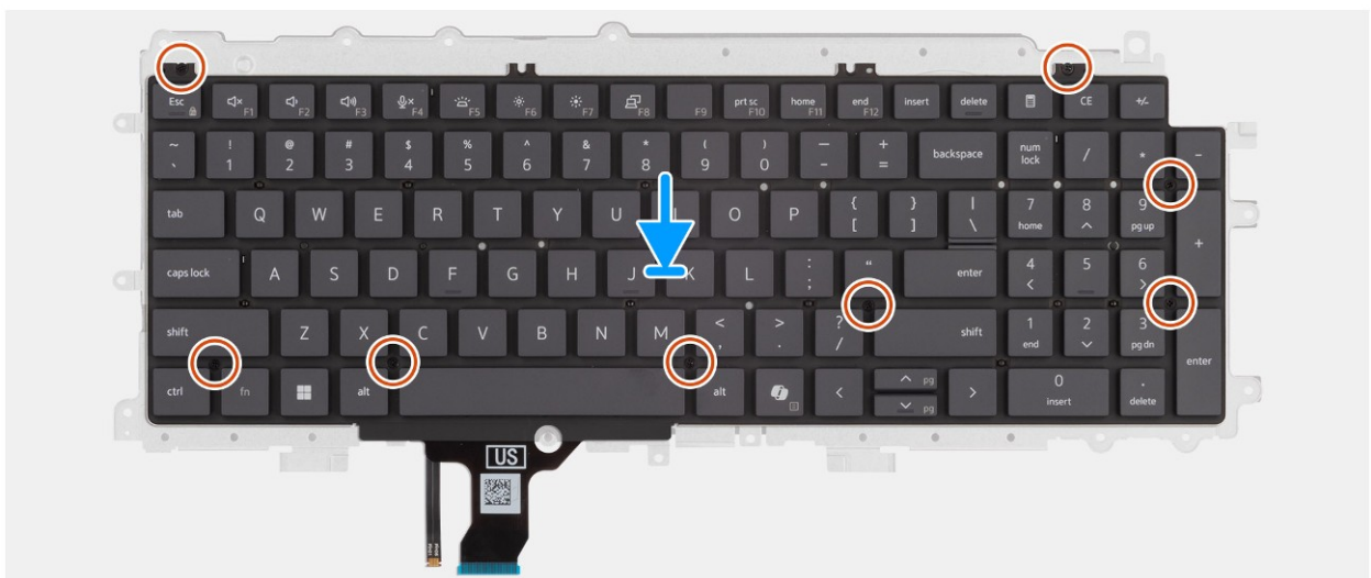
Rysunek 59. Instalowanie płyty nośnej klawiatury
