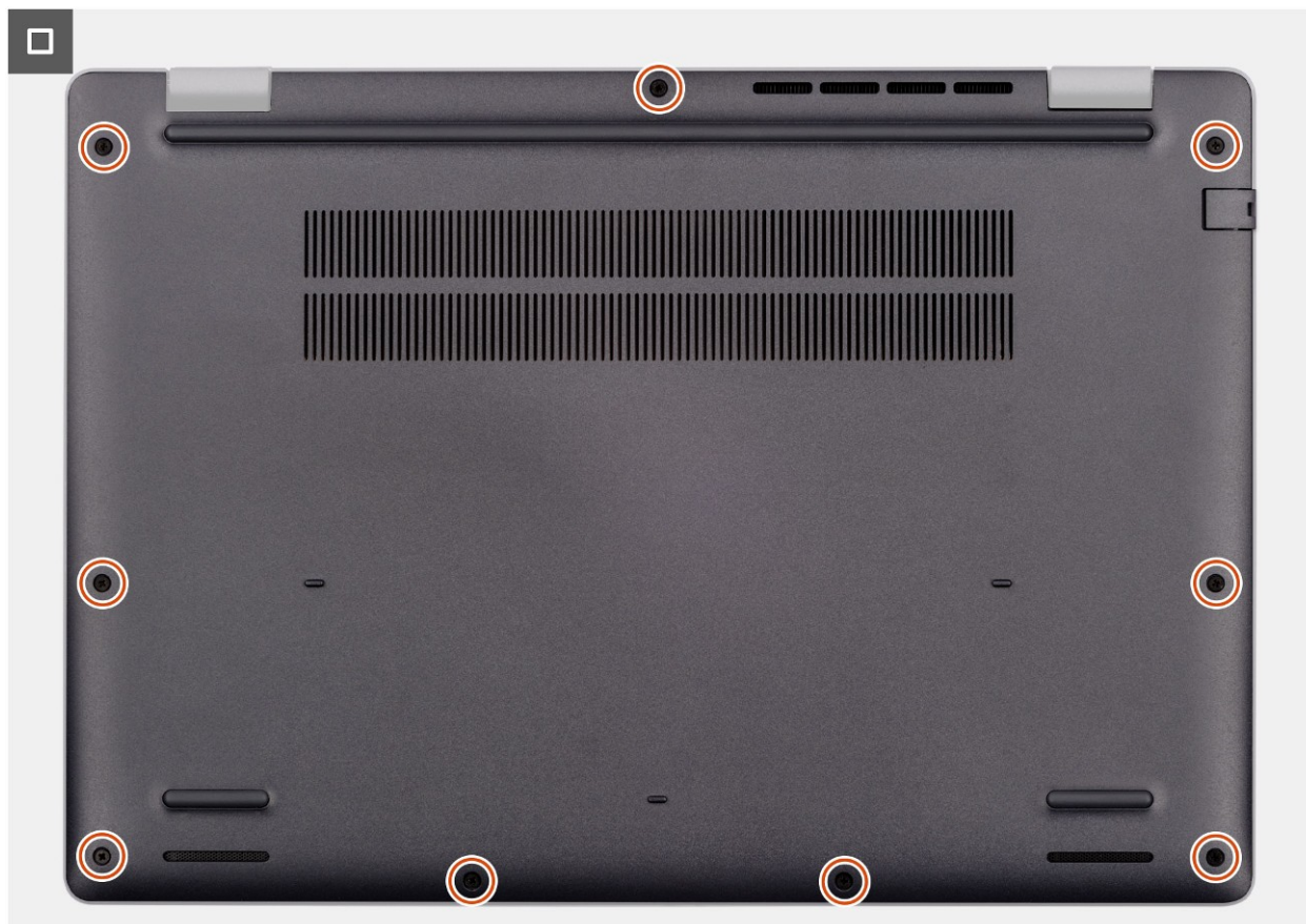
Rysunek 16. Instalowanie pokrywy dolnej
