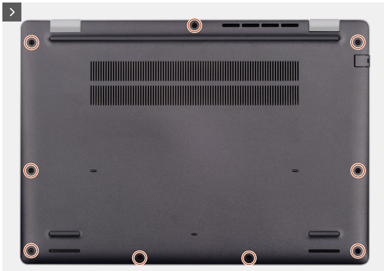
Rysunek 11. Wymontowywanie pokrywy dolnej
