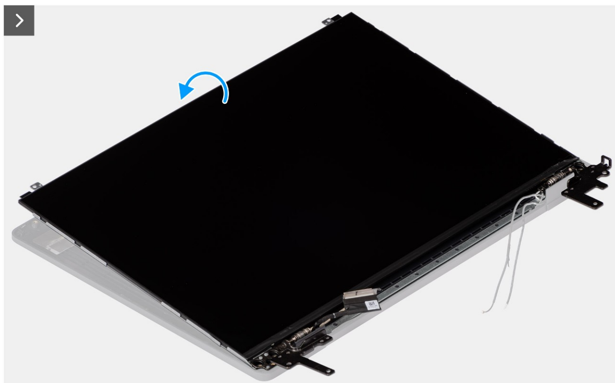
Rysunek 80. Instalowanie zestawu panelu wyświetlacza
