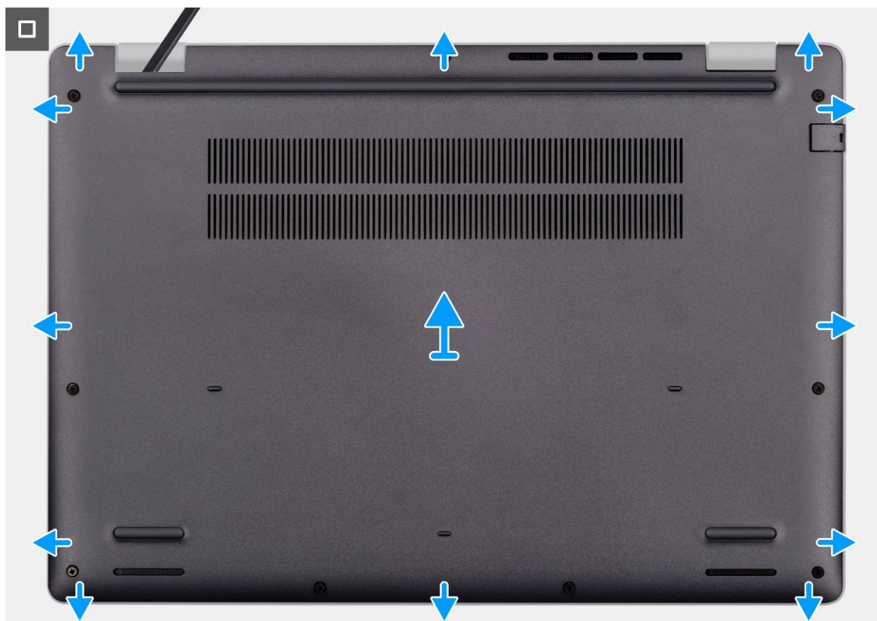
Rysunek 12. Wymontowywanie pokrywy dolnej
