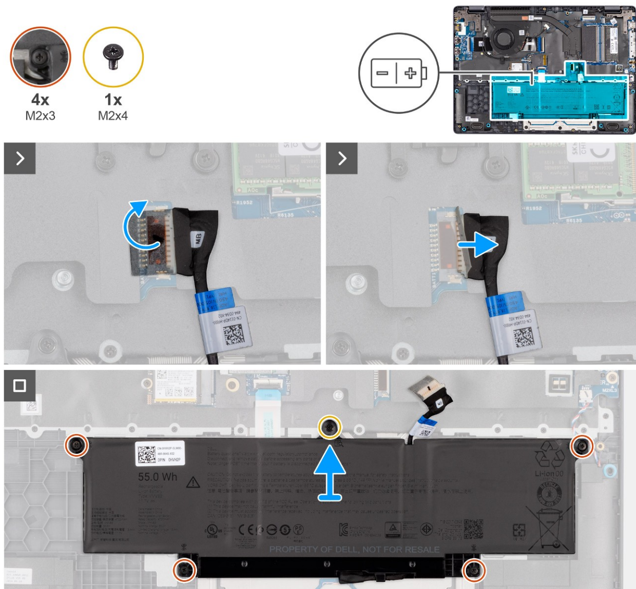
Rysunek 17. Wymontowywanie baterii
