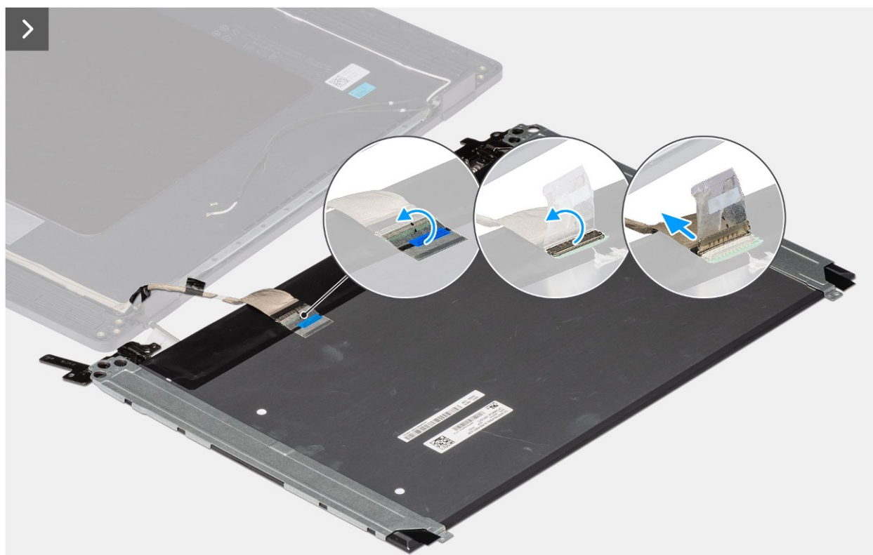
Rysunek 76. Wymontowywanie zestawu panelu wyświetlacza
