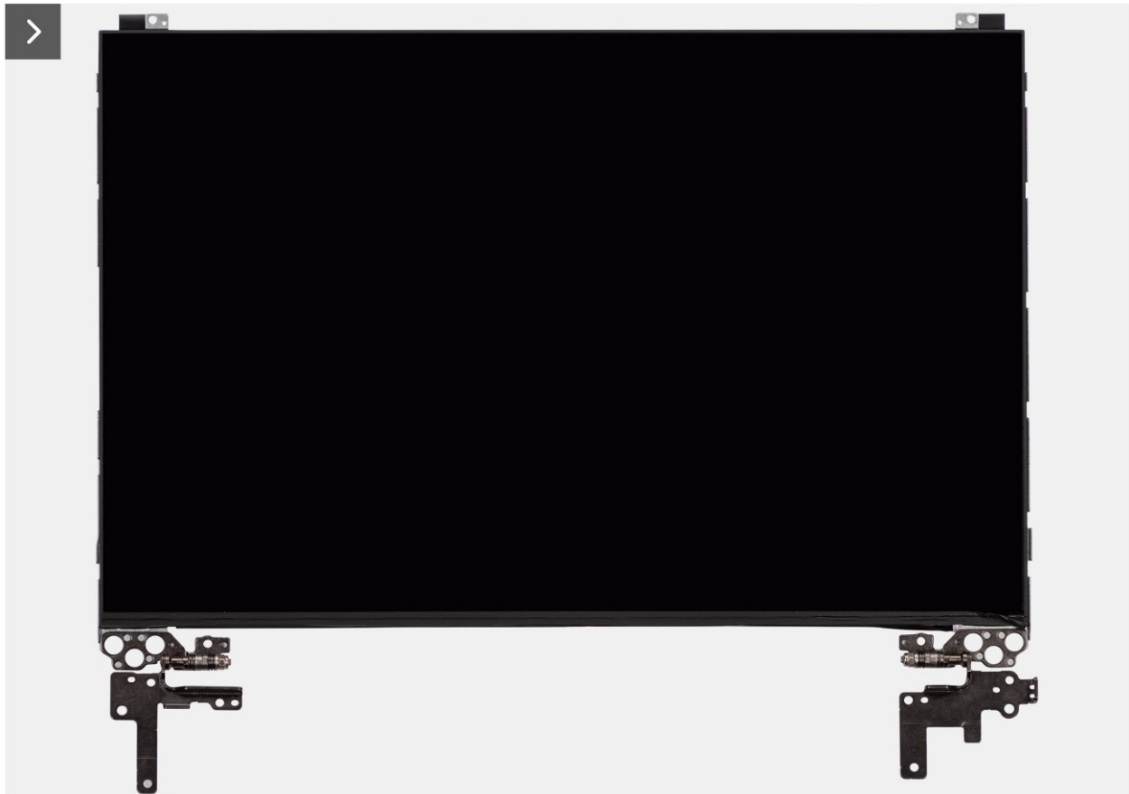
Rysunek 78. Instalowanie zestawu panelu wyświetlacza
