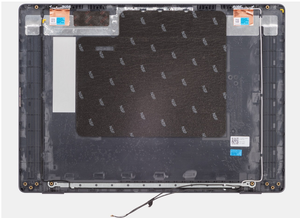
Rysunek 87. Instalowanie zestawu pokrywy tylnej wyświetlacza
