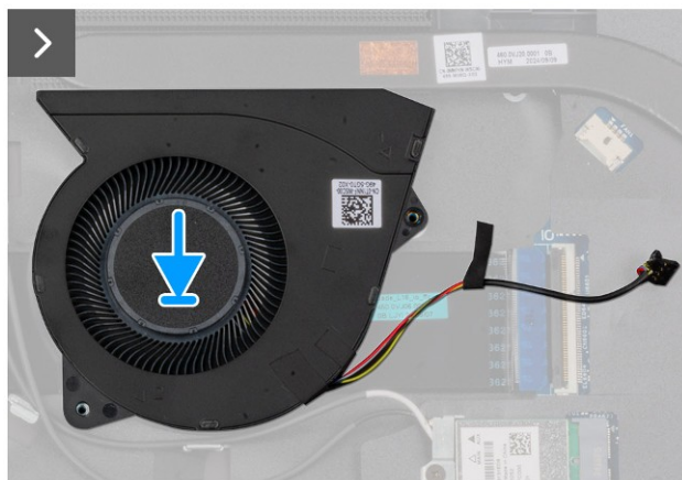
Rysunek 31. Instalowanie wentylatora
