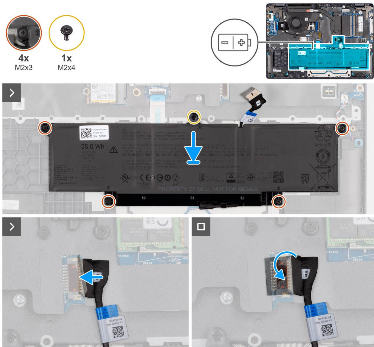
Rysunek 18. Instalowanie baterii
