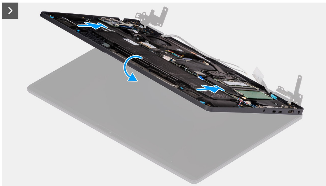
Rysunek 65. Instalowanie zestawu wyświetlacza
