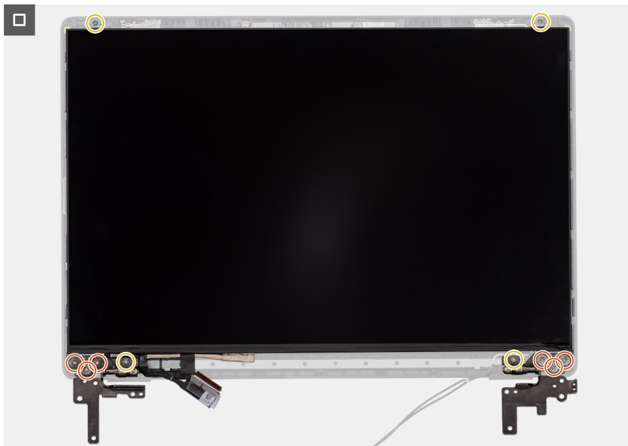
Rysunek 81. Instalowanie zestawu panelu wyświetlacza
