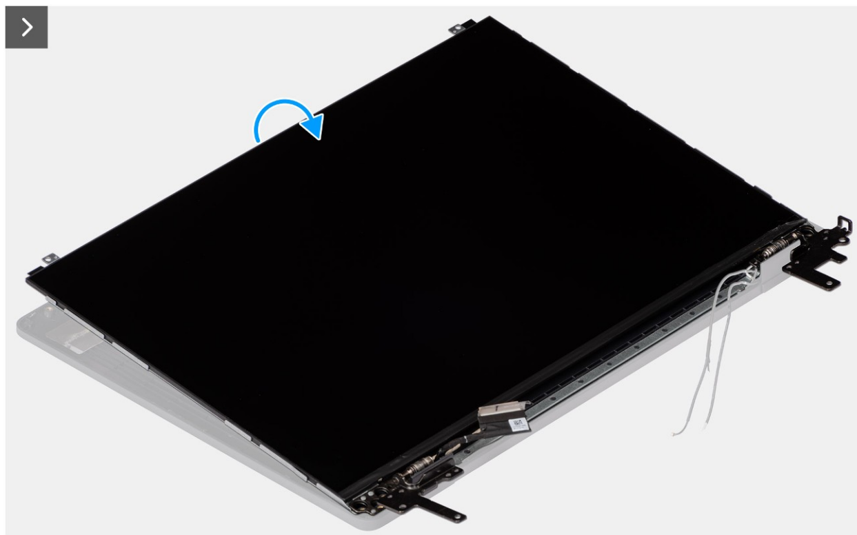
Rysunek 75. Wymontowywanie zestawu panelu wyświetlacza
