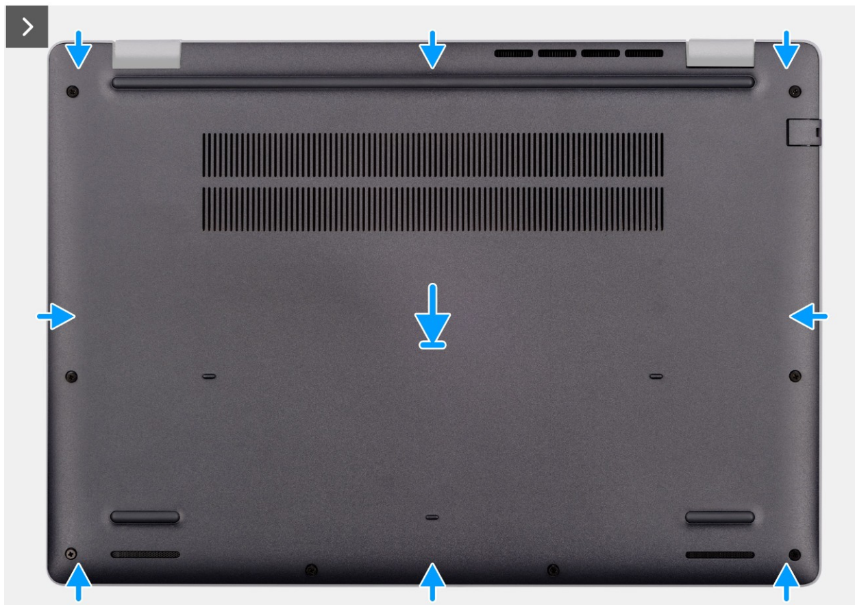
Rysunek 15. Instalowanie pokrywy dolnej
