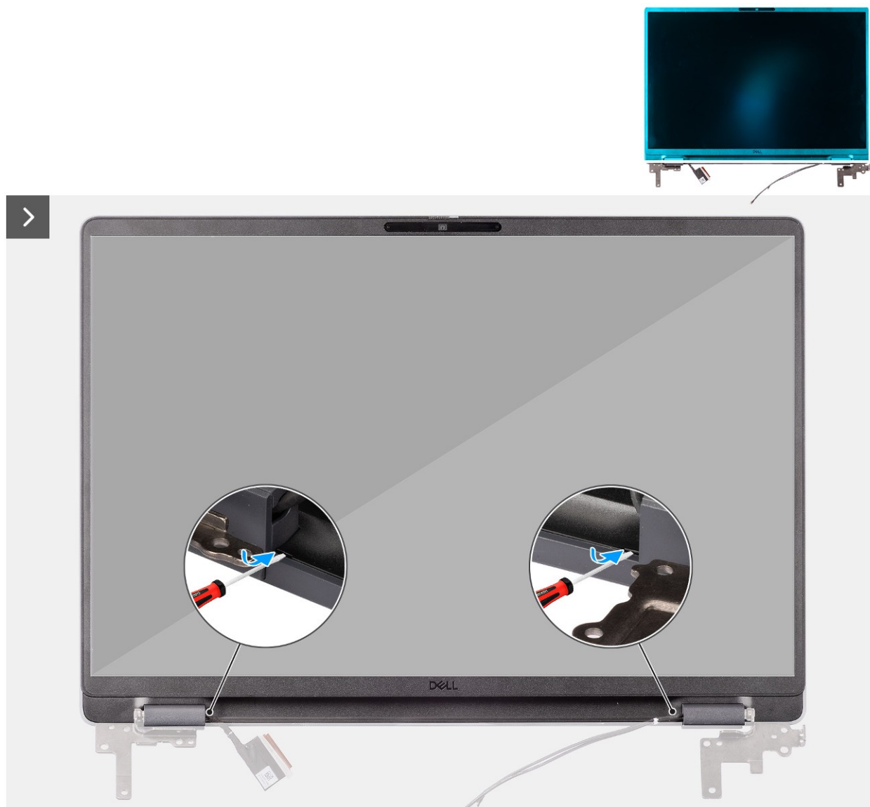
Rysunek 67. Wymontowywanie ramki wyświetlacza
