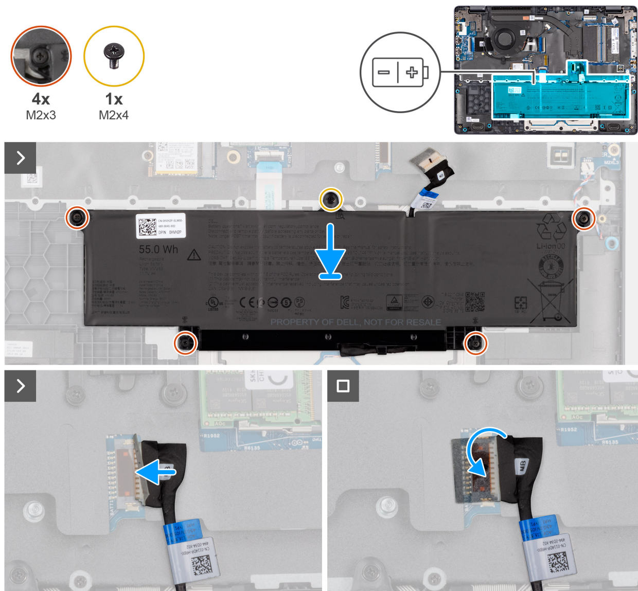
Rysunek 18. Instalowanie baterii
