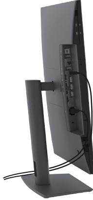
Rysunek 52. Podłącz przewody w najwyższej, najbardziej obróconej pozycji obrotu
