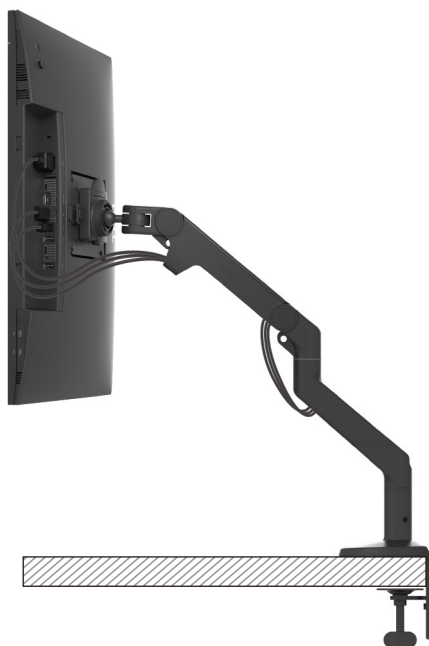
Rysunek 35. Podłącz kable przy ustawieniu monitora w najwyższym położeniu i maksymalnie obróconym w osi
