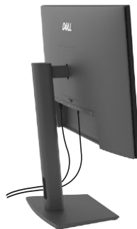
Rysunek 53. Upewnij się, że pozostawiono wystarczającą długość przewodu na ruch monitora
