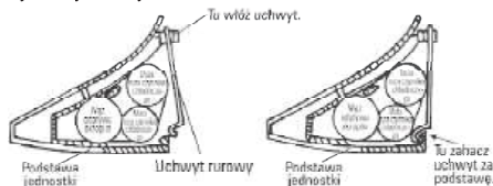
B. Naciśnij uchwyt, żeby zahaczył za podstawę jednostki wewnętrznej.
