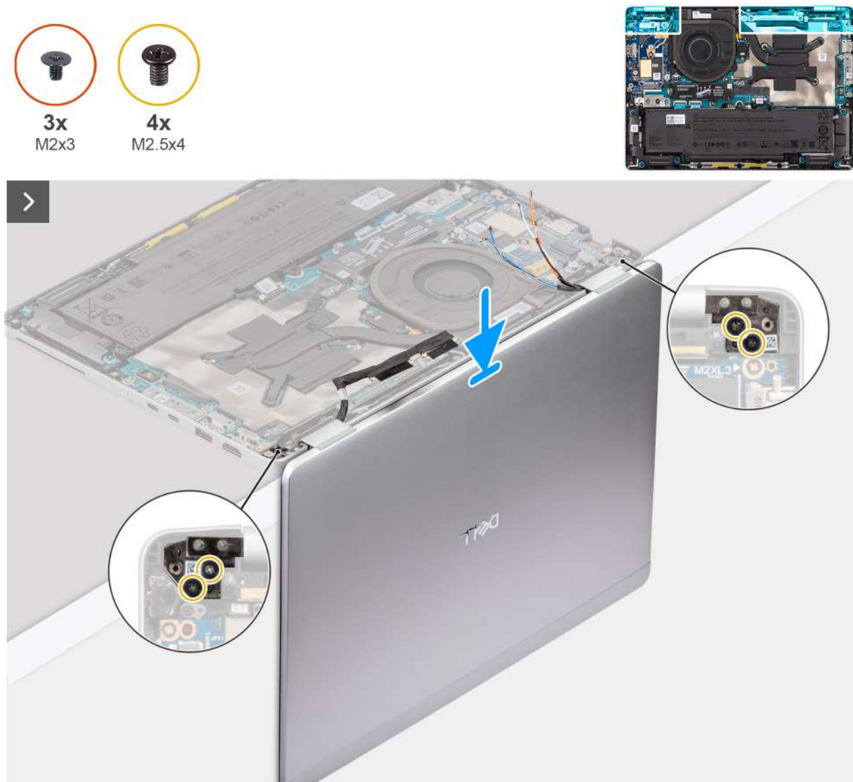
Rysunek 63. Dopasowywanie zestawu wyświetlacza do zestawu podpórki na nadgarstek
