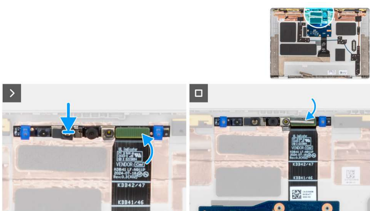
Rysunek 84. Instalowanie kamery MIPI
