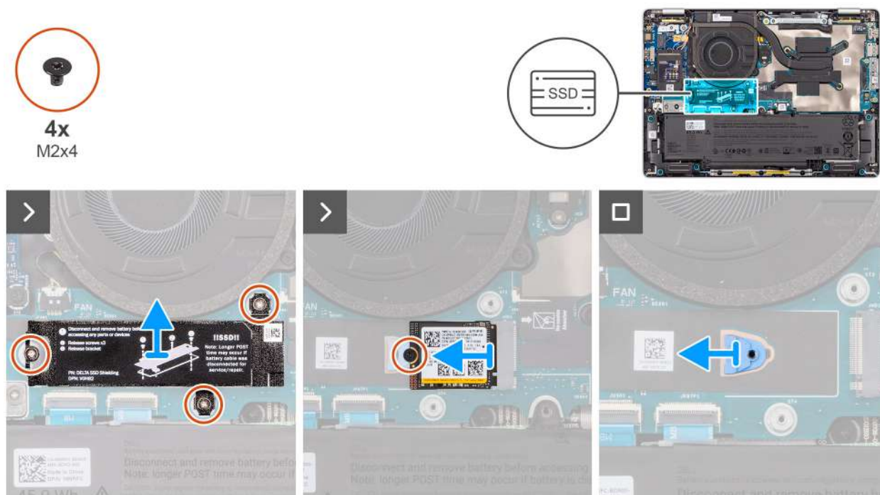
Rysunek 31. Wymontowywanie dysku SSD M.2 2230
