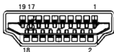
19-stykowy przewód sygnałowy kolorowego wyświetlacza
