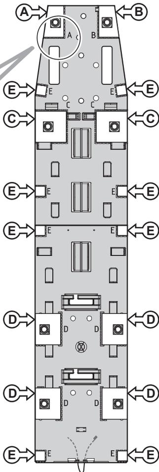
**IT** Per il fissaggio a muro dei particolari 1 e 2 è previsto l'uso di biadesivo. • Alternativamente all'uso del biadesivo (in dotazione), i particolari 1 e 2 possono essere fissati con tasselli (non forniti). • I supporti di TV e dispositivi Audio/Video devono comunque essere montati tramite tasselli, come indicato nei punti successivi.
