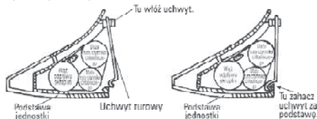
B. Naciśnij uchwyt, żeby zahaczył za podstawę jednostki wewnętrznej.
