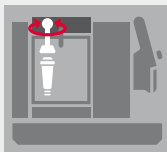
Wykręcanie / wkręcanie filtra (w zbiorniku na wodę)
