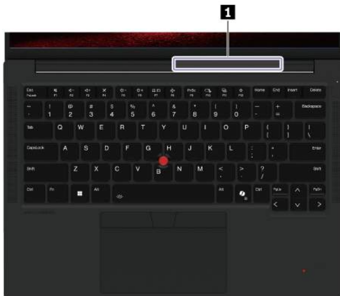
1 Antena sieci bezprzewodowej LAN
