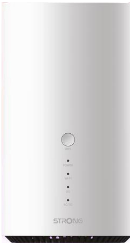
Rys. 2 — Przedni panel: przycisk WPS i wskaźniki LED
