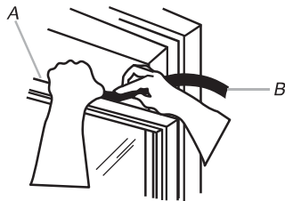
A. Rama dolnego skrzydła okiennego B. Uszczelka piankowa
