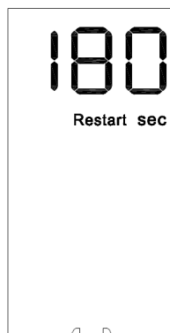
Estado de protección del compresor
