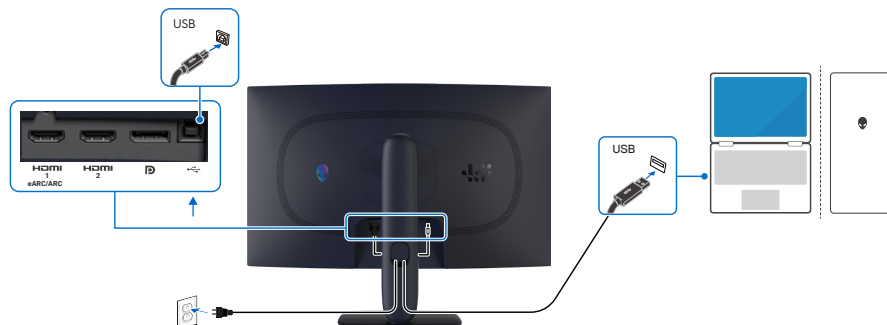
Rysunek 26. Podłączenie kabla USB Type-B (Type-B do Type-A)
