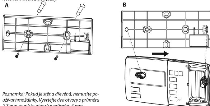
*Poznámka: Pokud je stěna dřevěná, nemusíte používat hmoždinky. Vyrťte dva otvory o průměru 2,7 mm namísto otvorů o průměru 6 mm.*
