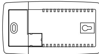
Bohren Sie in die Wand zwei Löcher mit Durchmesser 6 mm.
