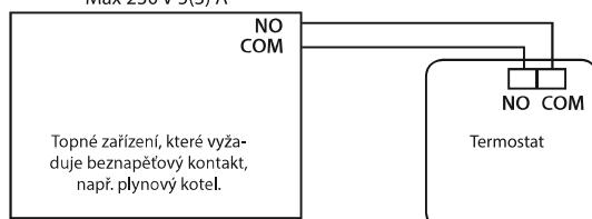
\* V případě, že se jedná o kotel NC, termostat by měl být nastaven v režimu CHLAZENÍ (COOLING).
