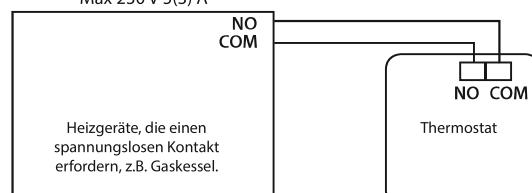
\* Falls es sich um einen NC-Kessel handelt, sollte der Thermostat im Modus KÜHLUNG (COOLING) eingestellt sein.
