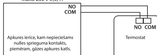
\* Ja tiek lietots NC boilers, termostats jāiestata dzesēšanas režimā (COOLING).
