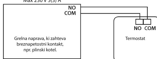
\* V primeru, da gre za kotel NC, naj je termostat nastavljen na način HLAJENJE (COOLING).
