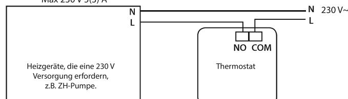
\* Falls es sich um einen NC-Kessel handelt, sollte der Thermostat im Modus KÜHLUNG (COOLING) eingestellt sein.
