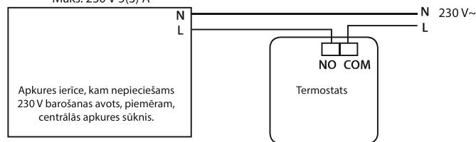
\* Ja tiek lietots NC boilers, termostats jāiestata dzesēšanas režimā (COOLING).
