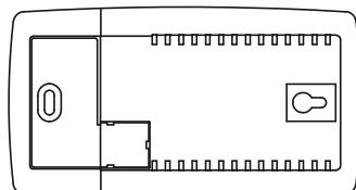
Примітка: якщо стіна дерев'яна, не обов'язково використовувати дюбелі. Просвердліть два отвори діаметром 2,7 мм замість отвору діаметром 6 мм.
