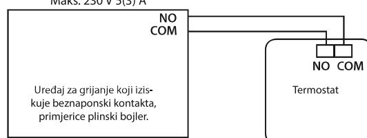
\* Ako se radi o bojleru NC, termostat treba postaviti u način HLAĐENJE.
