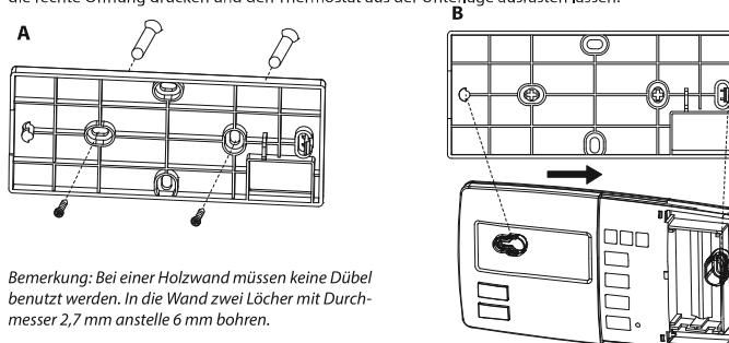
*Bemerkung: Bei einer Holzwand müssen keine Dübel benutzt werden. In die Wand zwei Löcher mit Durchmesser 2,7 mm anstelle 6 mm bohren.*
