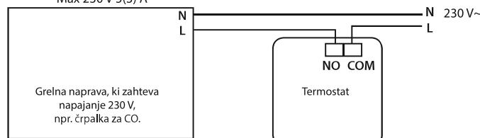
\* V primeru, da gre za kotel NC, naj je termostat nastavljen na način HLAJENJE (COOLING).
