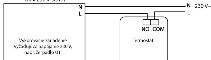
\* V prípade, že sa jedná o kotel NC, termostat by mal byť nastavený v režime CHLADENIA (COOLING).
