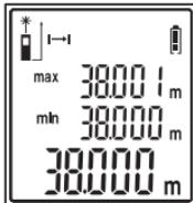
Für die gesamte Dauer des kontinuierlichen Messens wird das Gerät ein akustisches Signal ausgeben.
