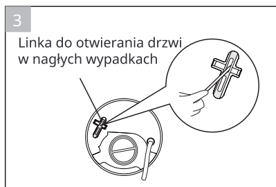
3. Włóż narzędzie do pierścienia ściągacza i pociągnij w dół, aby odblokować drzwi maszyny
