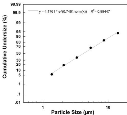
Les mesures ont été effectuées avec une solution de fluorure de sodium à l'aide d'un impacteur NGI (Next Generation Impactor).
