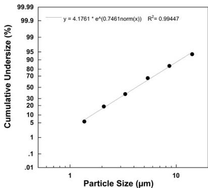
Las mediciones se realizan con una solución de fluoruro sódico con un "Next Generation Impactor" (NGI).
