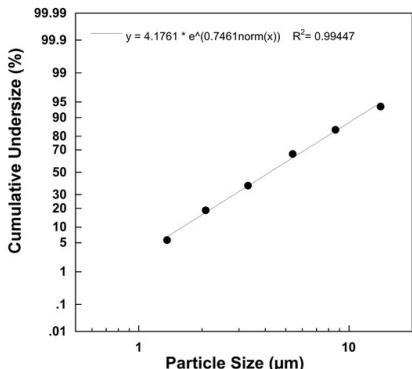
Измерения производились с использованием раствора фторида натрия при помощи импактора нового поколения (Next Generation Impactor = NGI).
