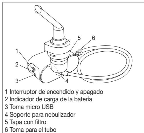
1 Interruptor de encendido y apagado
