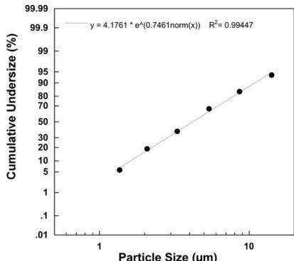
Die Messungen wurden mit einer Natrium-Fluorid-Lösung mit einem „Next Generation Impactor“ (NGI) durchgeführt. Das Diagramm ist möglicherweise so nicht auf Suspensionen oder sehr zähflüssige Medikamente anwendbar. Nähere Informationen dazu können Sie vom jeweiligen Medikamentenhersteller erfahren.
