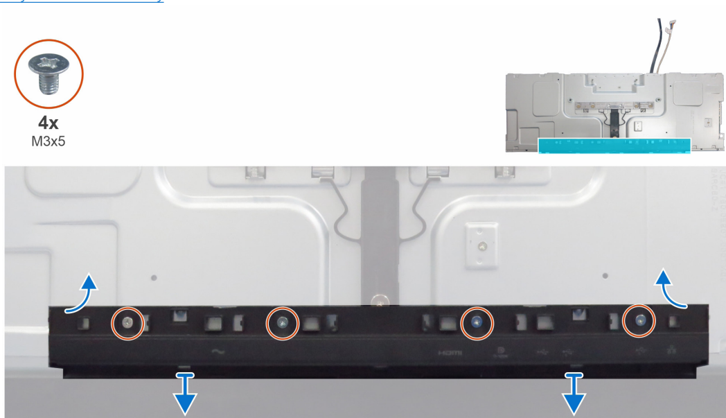
Rysunek 23. Zdejmowanie osłony we/wy
