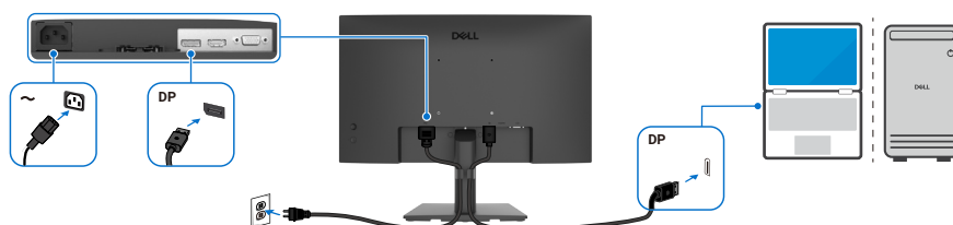
Rysunek 16. Podłączanie przewodu DP
