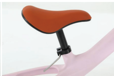
4. Nejprve uvolněte zámek a poté nastavte sedadlo do vhodné výšky. K utažení zámku použijte klíče ve tvaru L.
