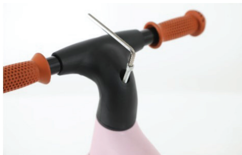
3. Utilizzare chiavi a L per serrare saldamente il bullone.
