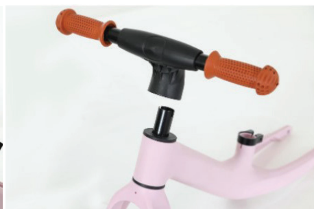
2.º Coloque o guidador no tubo do garfo. Ligue-os.
