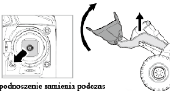
podnoszenie ramienia podczas opuszczania łyżki
