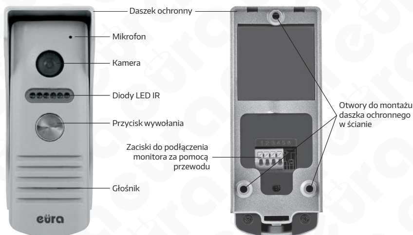
Rys. 2 Budowa kasety zewnętrznej VDA-13A3
