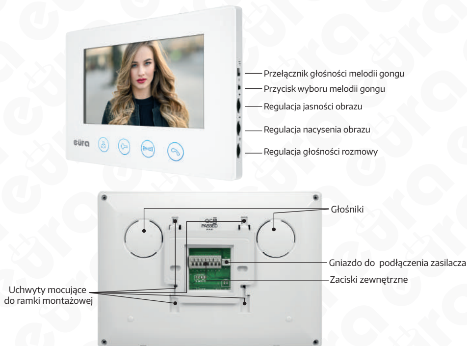
Rys. 1. Budowa monitora VDA-40A3
