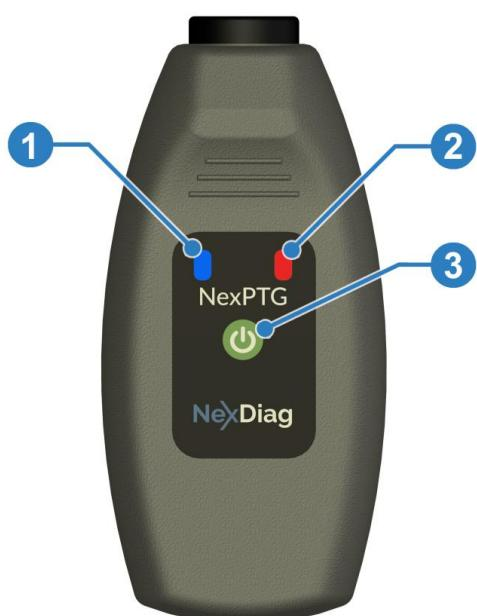
Pro uvedení měřiče **NexPTG** do provozu podržte **3 sekundy** tlačítko ③ až do okamžiku, kdy se na panelu rozsvítí napájecí dioda ②. Otevřete aplikaci **NexPTG** na mobilním zařízení (vnějším). Správná komunikace je signalizována svítící modrou diodou ①.
