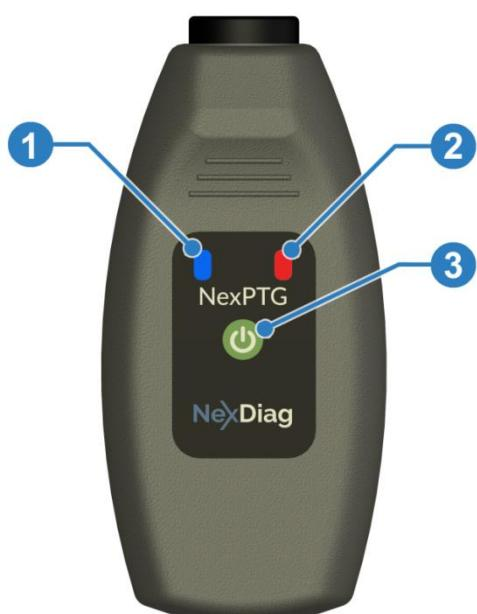
Um das Messgerät **NexPTG** in Betrieb zu nehmen, ist 3 Sekunden lang Button 3 zu halten, bis auf dem Panel die Versorgungsdiode 2 leuchtet. Dann nehmen wir die App **NexPTG** auf dem mobilen (externen) Gerät in Betrieb. Die ordnungsgemäße Kommunikation wird signalisiert, indem die blaue Diode 1 angeht.
