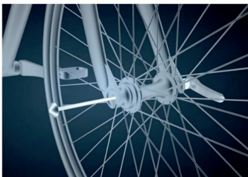
Rysunek 2 – włóż „szpilkę” przez koło, dokręć nakrętkę po lewej stronie, aby szybkozamykacz zaciskał się z odpowiednim oporem
