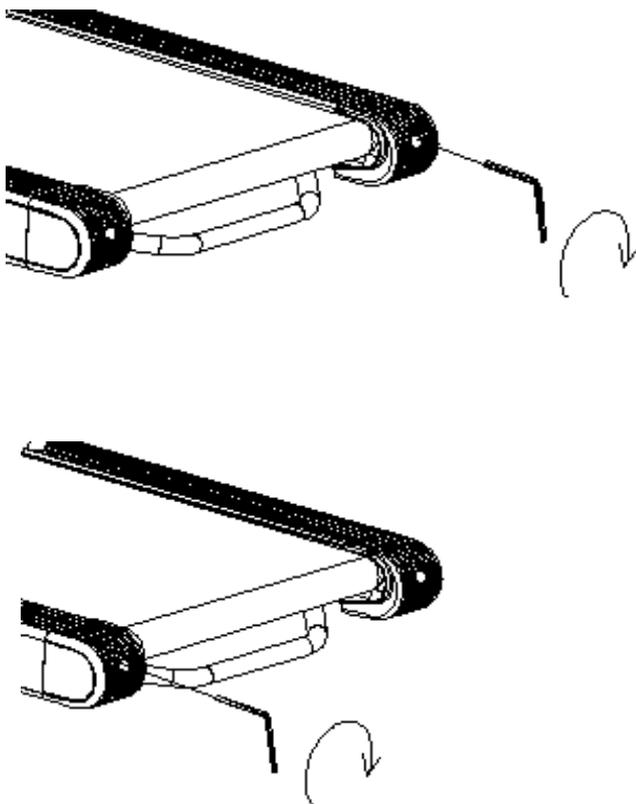
SMAROWANIE PASA BIEŻNEGO/ LUBRICATING THE TREADMILL BELT/ СМАЗКА БЕГОВОЙ ДОРОЖКИ/ MAZÁNÍ BĚŽECKÉHO PÁSU/ MAZANIE BEŽECKÉHO PÁSU/ BĒGIMO JUOSTOS TERPIMAS/ SKREJCEĻA JOSLAS EĻĻOŠANA / SCHMIERUNG DER LAUFMATTE
