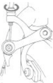
rys. 12b regulacja napięcia linki hamulca
