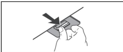
Aktivní filtr z dřevného uhlí není vhodný pro čištění a obnovu a je nutné ho měnit cca. každé 4 měsíce provozu nebo častěji, a v případě zvláště intenzivního používání ještě častěji.
