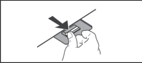
Le filtre à charbon de bois activé ne doit pas être nettoyé, est irremplaçable et doit être remplacé tous les 4 mois d'utilisation ou plus souvent en cas d'utilisation particulièrement intensive.
