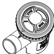
Pour améliorer l'efficacité de la thérapie par inhalation, tourner le sélecteur de vitesse (C1.2.3) dans le sens contraire des aiguilles d'une montre, dans ce cas, vous obtiendrez une acquisition optimale du médicament en minimisant sa dispersion dans l'environnement.
