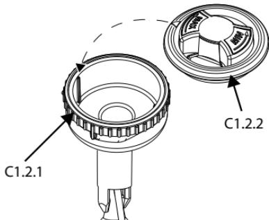
انتبه، يجب تثبيت دعامة محدّد الاختيار (C1.2.2) تمامًا في الجزء العلوي (C1.2.1) وللتتمكن من فعل ذلك يجب عليك محاذاة السهم الموجود على دعامة محدّد الاختيار مع مقبض توصيل الملحقات التشغيلية. انظر الصورة التوضيحية.
