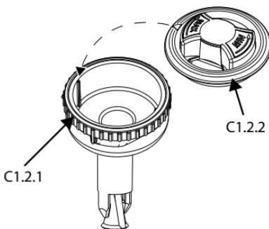
3. Vierta la medicina recetada por el médico por la parte inferior (C1.1). Introduzca la parte superior (C1.2) en la parte inferior (C1.1); cierre el nebulizador girando la parte superior (C1.2) hacia la derecha.
