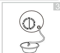
Po spuszczeniu wody odłóż wąż na miejsce
