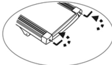
Drehen Sie gegen den Uhrzeigersinn, um die Spannung des Bandes zu verringern
