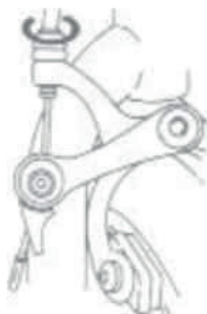
rys. 12b regulacja napięcia linki hamulca
