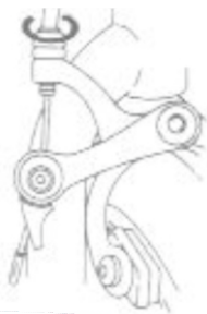
rys. 12b regulacja napięcia linki hamulca
