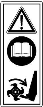
Leggere il manuale prima di usare la macchina - Attenzione: rotazione fresa.
