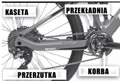
Układ napędowy z korbą, kasetą, przerzutką przednią i tylną.
