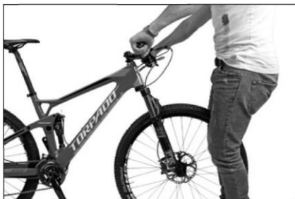
Spróbuj przesunąć kierownicę względem przedniego koła.
