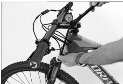
Ustawienie stałej sprężyny za pomocą pompki amortyzatora.
