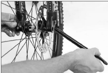
Wyciąganie sworznia przelotowego
