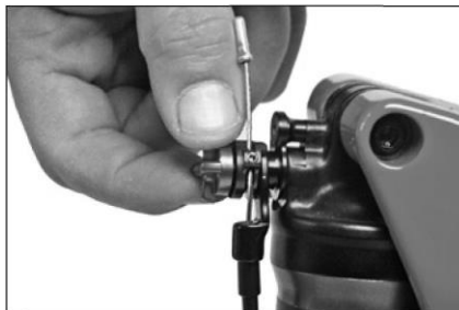
Amortyzacja jest regulowana za pomocą pokrętki regulacyjnego.
