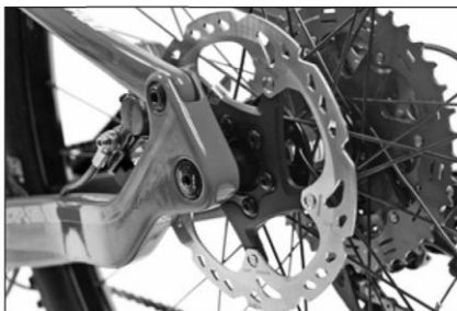
System z osią piasty przelotowej 12 mm
