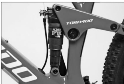
Przesunięcie O-ring'u na amortyzatorze wskazuje zastosowany skok.
