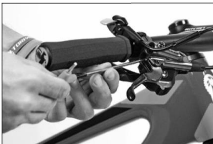
Regulacja odległości dźwigni hamulca
