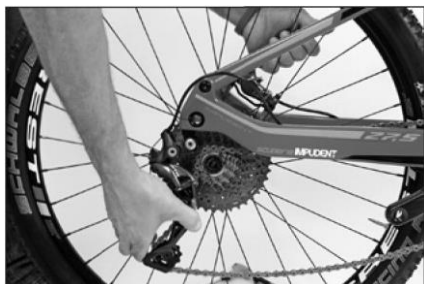
Aby zdjąć tylne koło, należy lekko przesunąć przerzutkę do tyłu.
