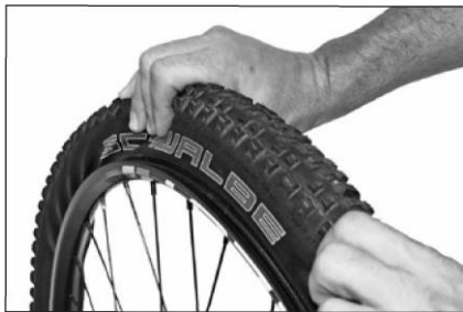
Wepchnij oponę w kierunku środka obręczy.
