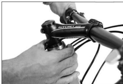
Aby sprawdzić luz w sterach należy zaciśnąć hamulec przedni, mocno popychając rower do tyłu i do przodu, opierając się tułowiem na siodle.
