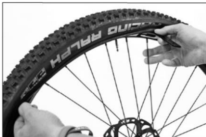
Umieść łyżkę montażową i unieś bok opony, obracając ją na obręczy.
