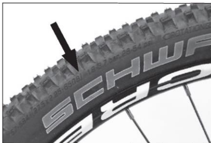
Wskazanie maksymalnego ciśnienia napompowania na boku opony.
