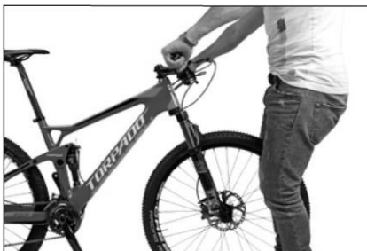
Spróbuj przesunąć kierownicę względem przedniego koła.
