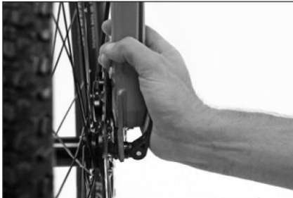
Zamykanie szybkozamykacza dłonią.
