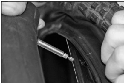
Włożyć wentyl do otworu obręczy.
