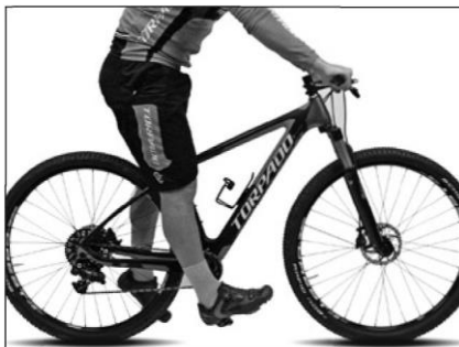
Kiedy pięta znajduje się na pedale, który znajduje się w najniższej pozycji, noga powinna być maksymalnie wysunięta.
