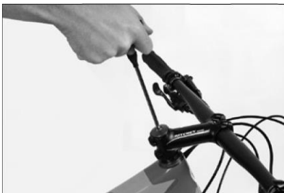
Po poluzowaniu bocznych dźwigni blokujących należy wyregulować luzy kierownicy za pomocą wpuszczanej śruby regulacyjnej u góry.
