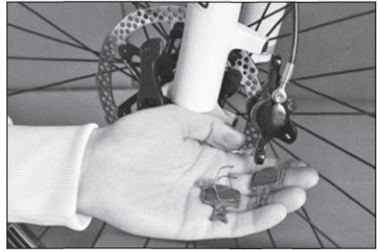
Wymienić zużyte klocki hamulcowe
