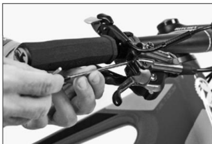
Ustawianie odległości dźwigni hamulca kierownicy
