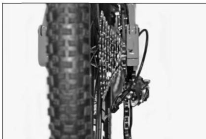
Od tyłu spójrz na kasety i sprawdź, czy tylne kółka przerzutek znajdują się dokładnie pod odpowiednią zębatką.
