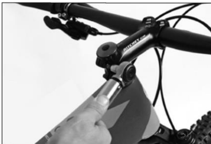
Ponownie dociągnąć dźwignie boczne wspornika kluczem dynamometrycznym.
