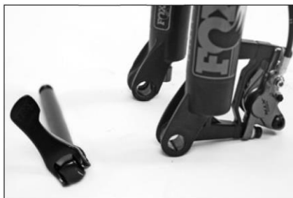
System z osią piasty przelotowej 15 mm
