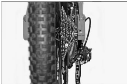
Przesuń łańcuch na najmniejszą zębatkę.
