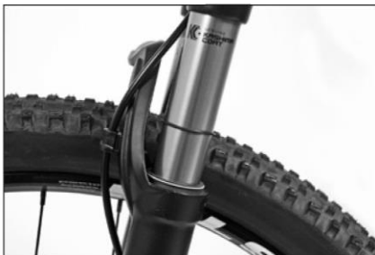
Na podstawie przemieszczenia zacisku, można określić zastosowany skok.
