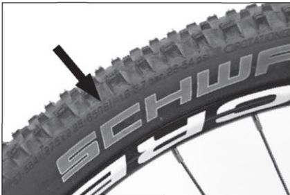
Wskazanie maksymalnego ciśnienia napompowania na boku opony.
