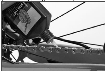
Łańcuch należy nasmarować po oczyszczeniu.
