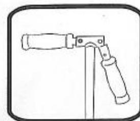
4. Выньте обе ручки из поперечной трубки руля.
