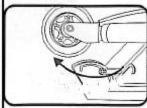
6. Зафиксируйте блокирующий механизм.
