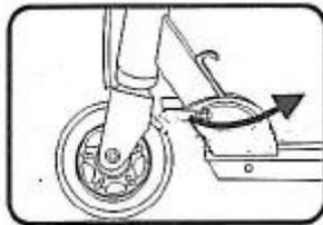
6. Зафиксируйте блокирующий механизм.
