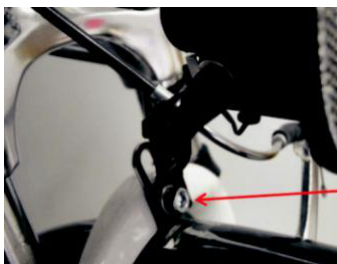
ŚRUBA MOCUJĄCA UCHWYT LAMPY I BŁOTNIKA PRZEDNIEGO
