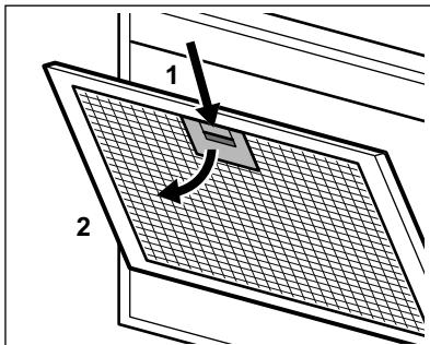
3. Kallutage filtri esiosa kergelt allapoole (2), seejärel tömmake. Korra kahte esimest sammu kõigi filtritega.
