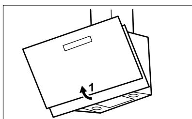
2. Stlačte rukoväť montážnej príchytky na paneli s filtrom na dolnej strane odsávača párov (1).
