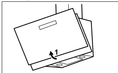
2. Πιέστε τη λαβή του κλιπ στερέωσης στο πλαίσιο του φίλτρου κάτω από τον απορροφητήρα (1).
