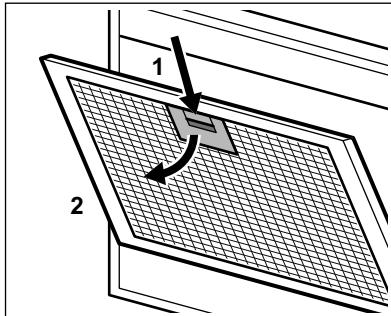
3. Злегка наклоніть передню частину фільтра вниз (2), потім потягніть. Повторіть перші два кроки для всіх фільтрів.
