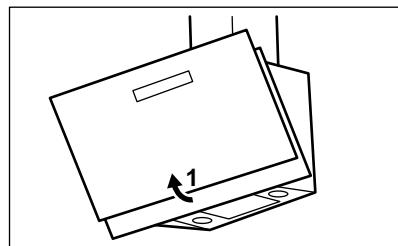
2. Натисніть ручку затискача кріплення на панелі фільтра під витяжкою (1).
