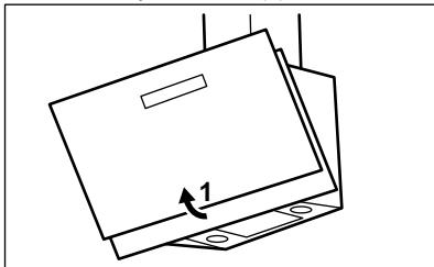
2. Tryck ner handtaget på monteringsklämman på filterpanelen under fläkten (1).
