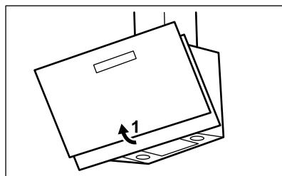
2. Tryk på grebet til monteringsclipsen på filterpanelet under emhætten (1).
