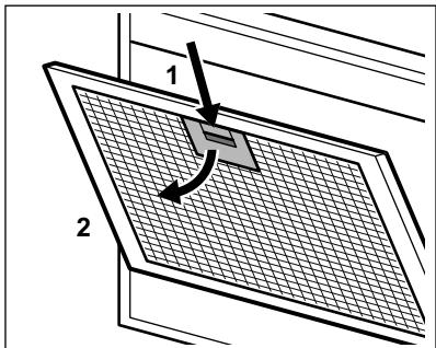
3. Înclinați ușor partea frontală a filtrului în jos (2), după care trageți. Repetați primii doi pași pentru toate filtrele.
