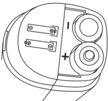
3. Vuelva a colocar la tapa del compartimento hasta que note que encaja.
