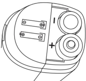
3. Setzen Sie die Abdeckung wieder auf das Batteriefach, bis sie spürbar einrastet.
