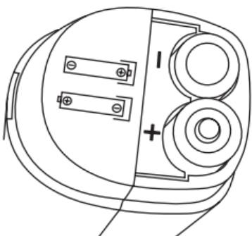
3. Replacez le couvercle sur le compartiment à piles jusqu'à ce qu'il s'enclenche.
