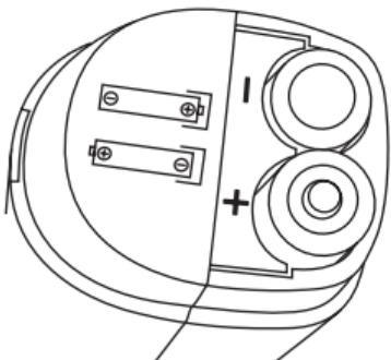
3. Załóż pokrywę na komorę baterii i zamknij, aż usłyszysz kliknięcie.
