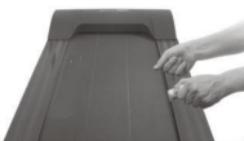
Τραβήξτε καλά τον ιμάντα κίνησης. Στη συνέχεια, βάλτε το λάδι σιλικόνης στο πινάκα τρεξίματος. Στη συνέχεια ξεκινήστε το μηχάνημα για 3 λεπτά χωρίς φόρτωση. Είναι προτιμότερο να διατηρείται έτοι κάθε 30 ώρες λειτουργίας του μηχανήματος. Αυτό μπορεί να εξοικονομήσει σωστά τη διάρκεια ζωής των εξαρτημάτων.
