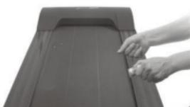
Ziehen Sie das Band fest. Tragen Sie das Silikonöl auf. Schalten Sie dann das Gerät für 3 Minuten ohne Last ein. Es wird empfohlen, die obige Tätigkeit alle 30 Stunden des Betriebs zu wiederholen. Damit wird die Lebensdauer des Geräts verlängert.
