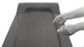
Čvrsto povucite traku za trčanje. Nakon toga nanesite silikonsko ulje. Zatim pustite uređaj 3 minute bez opterećenja. Gornji postupak preporučuje se ponoviti svakih 30 sati rada uređaja. To će vam pomoći produžiti život dijelova.
