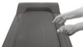
Сильно потяните беговую ленту. Затем нанесите силиконовое масло. Затем запустите машину на 3 минуты без нагрузки. Вышеуказанную процедуру рекомендуется повторять каждые 30 часов работы машины. Это поможет продлить срок службы деталей.
