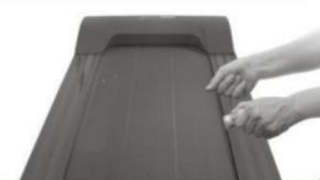
Silně naahněte běžecký pás. Poté aplikujte silikonový olej. Poté spusťte stroj 3 minuty bez zatížení. Výše uvedená činnost se doporučuje opakovat každých 30 hodin provozu stroje. To pomůže prodloužit životnost dílů.
