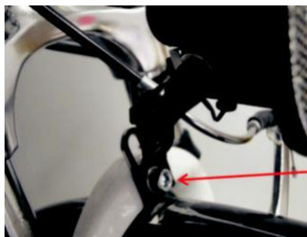
ŚRUBA MOCUJĄCA UCHWYT LAMPY I BŁOTNIKA PRZEDNIEGO
