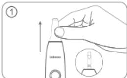
Entfernen Sie die Schutzkappe der Antriebswelle in die richtigen Richtung.
