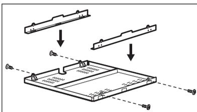
W przypadku zastosowania kasety ochronnej (wyposażenie dodatkowe<sup>1)</sup>) nie jest konieczne zastosowanie osłony bezpośrednio pod urządzeniem.
