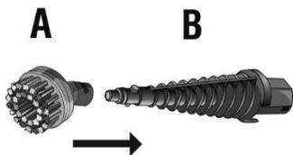
Vyberte si vhodný nástavec na čistenie (A), ktorý chcete použiť, nasadte ho na adaptér (B) a otočte ním v smere hodinových ručičiek pre pevne uzamknutie oboch dielov. Adaptér (B) potom zasuňte do tela Ručného čističa. Odstránenie Adaptéra (B) vykonáte stlačením sivého tlačidla na zadnej strane Ručného čističa.
