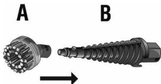
Válassza ki a megfelelő tisztító tartozékot (A), helyezze rá az adapterre (B) és csavarja el az óramutató járásával megegyező irányba. Ezután az adaptert dugja be a kézi gőztisztítóba. Az adapter eltávolításához nyomja meg a készülék hátoldalán található szürke gombot.
