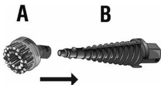
Izberite ustrezen nastavek za čiščenje (A), ki ga želite uporabiti. Položite ga na redukcijo (B) in ga obrnite v smeri urinega kazalca, da oba dela trdno zaklenete. Nato vstavite redukcijo (B) v ohišje ročnega čistilca.
