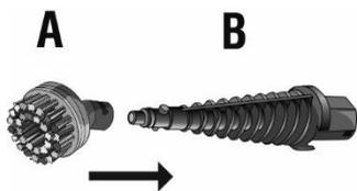
Izaberite odgovarajući nastavak za čišćenje (A), koji želite upotrebljavati, stavite na adapter (B) i okrećite u smjeru kazaljki na satu dok oba dijela nisu čvrsto spojena. Zatim umetnite adapter (B) u tijelo ručnog čistača.
