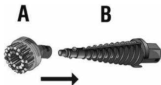
Alegeți accesoriul de curățare potrivit (A) pe care doriți să îl utilizați, plasați-l pe adaptor (B) și rotiți-l în sensul acelor de ceasornic pentru a bloca ferm ambele componente. Apoi introduceți adaptorul (B) în corpul Curățătorului manual. Pentru a scoate Adaptorul (B), apăsați butonul gri de pe partea din spate a Curățătorului manual.
