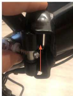
3. Podnieś dźwignię, aby odblokować ramę
